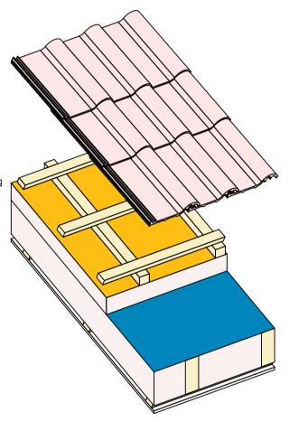
Dachsanierung von außen Steildach Regelaufbau, flächige Verlegung (2:1)
