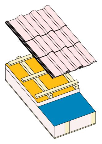
Dachsanierung von außen Steildach Regelaufbau, flächige Verlegung (3:1) Sanierungsdampfbremse DASAPLANO 0,01 (connect) von außen flächig verlegt.
